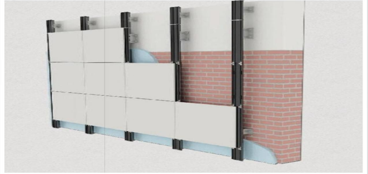
UYGULANAN SERAMİK KAPLAMA SİSTEM KESİTİ
